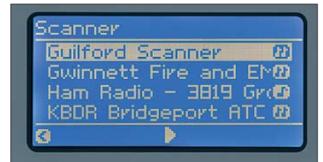
Bild 11: Amateurfunkempfang per Internet: Die Noxon-Stationsdatenbank führt auch den Datenstrom einer bekannten amerikanischen Amateurfunkrunde auf 3819 kHz [8].
