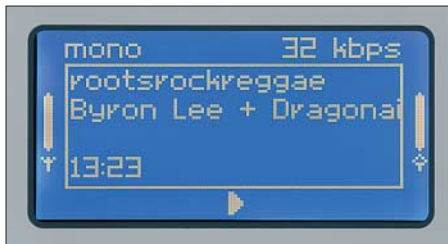
Bild 9: Das Radiodisplay zeigt neben dem Stationsnamen und Parametern des Audio Datenstroms in der zweiten Zeile Programm begleitende Informationen, wie den gerade gespielten Musiktitel. Über Symbole am linken und rechten Displayrand sind die WLAN-Empfangsgüte sowie der Füllstand des Datenzwischenspeichers ablesbar.
