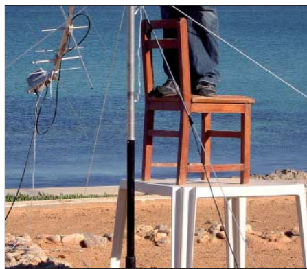
Not macht erfinderisch: Schnelle Montage des Moonbounce-Beams
