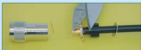
Bild 41: Schere oder Seitenschneider leisten beim Kürzen des Geflechts gute Dienste.
