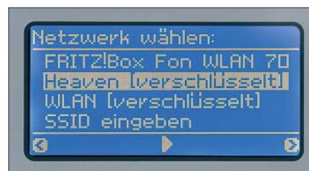
Bild 7: Bei der Installation zeigen die Noxon-Empfänger die vorhandenen WLAN-Netzwerke, aus denen man das gewünschte wählt. Die Verbindung ist durch Verschlüsselung geschützt.
