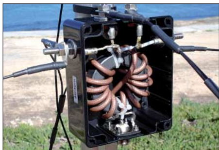
Die Einspeisebox des großen Spiderbeams
