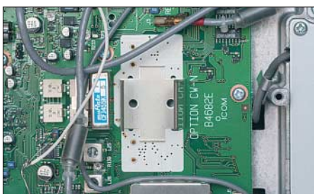
Bild 4: Ein schmales CW-Filter ist nachrüstbar.
