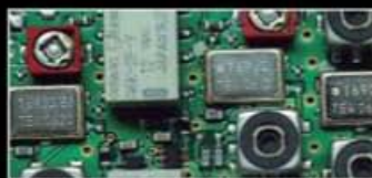
1. ZF: Drei Roofing-Filter bei 69,45 MHz
