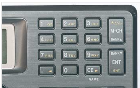
Bild 5: Frequenzen lassen sich per Zehertastatur eingeben oder aus einem der 1000 Speicherplätze abrufen.
