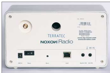
Bild 5: Noxon iRadio hält per WLAN oder Ethernet Kontakt zum Netzwerk. Funkantenne und Netzwerkkabel lassen sich auf der Rückseite anschließen.
