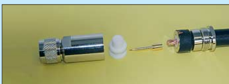
Bild 34: Die Innenisolation schneidet man vorsichtig bündig mit dem Kegel ab.
