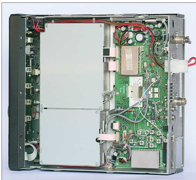
Bild 3: Der Innenaufbau orientiert sich an professioneller Empfangstechnik.
